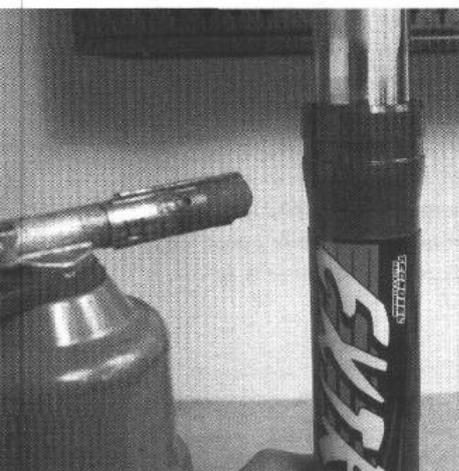
Buitenpoot verwarmen / Heating the outer tube / Äußeres Federbein erwärmen / Échauffement du bras extérieur / Riscaldamento del braccio esterno
