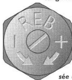
*Le réglage de la compression sur le bras gauche comporte 20 positions. On obtient la position la plus dure en tournant complètement, dans le sens des aiguilles d'une montre, la molette de réglage sur le bras intérieur. Au départ de cette position, revenez 4-5 crans en arrière pour un réglage dur ou 14-15 crans en arrière pour un réglage mou. Le réglage standard est établi à 10 crans en arrière.*
