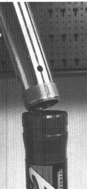
**Binnenpoot monteren / Reassembling the inner tube / Inneres Federbein montieren / Montage du bras intérieur / Montaggio del braccio interno**
